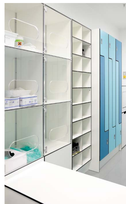
/// Links: Eintüriger Garderobenschrank sowie Bank zum Wechsel der Schuhe. Diese dient als Sit-Over-Barriere von Reinraum und Straßenschuhbereich. Rechts: Fächer mit Makrolonscheibe und Eingriff für die Entnahme von Reinraumartikel. Im Hintergrund Garderobenschränke in Z-Ausführung.
